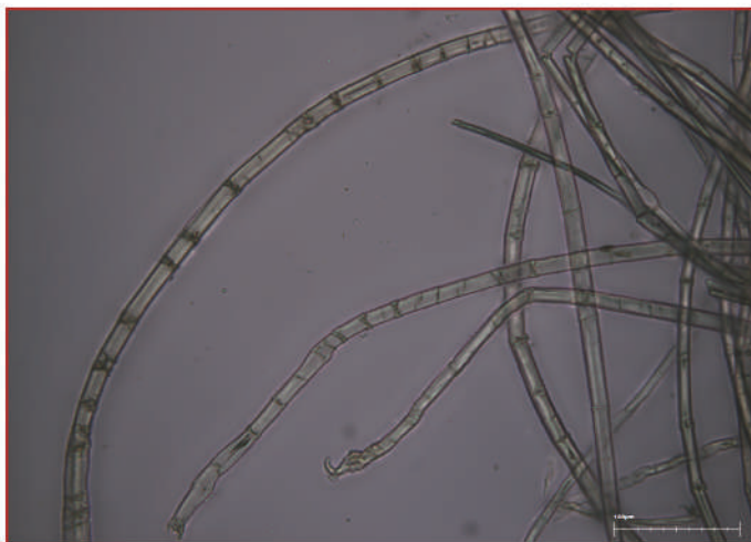
Figura 3: (a) Hajta mit-tila taħt mikroskopju ottiku; (b) fibri sseparati mill-hajta murija taħt ingrandiment għoli, bil-karatteristiċi tagħhom jikkonfermaw il-preżenza tal-kittien
